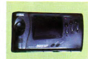
↑前几年才推出的掌上型主机NOMAD，对应“GENESIS（创世纪）”（也就是美国版的MD）的卡带系统。当然，日本的MD卡带也能使用。附液晶屏幕，直接插上卡带就能玩。
